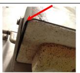
Dämmung Leichtbauplatte (hier: zwischen Gehäuse und Schamottstein)
