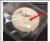
Drahtnetz mit Asbestbeschichtung
